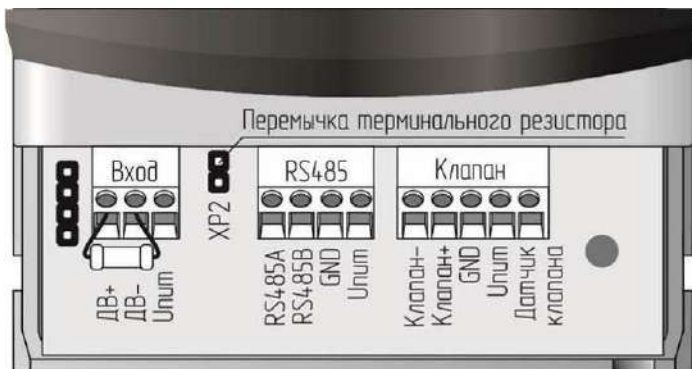
Рисунок В.2 – Расположение разъемов сигнализатора с одним RS485. Сигнализатор СЗ-1ЕВ не имеет разъема «Клапан».
